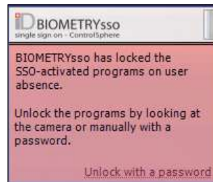
Ist der Nutzer nicht vor der Kamera, wird gesperrt.
